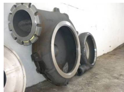
Cadre d'une pompe de dragage
