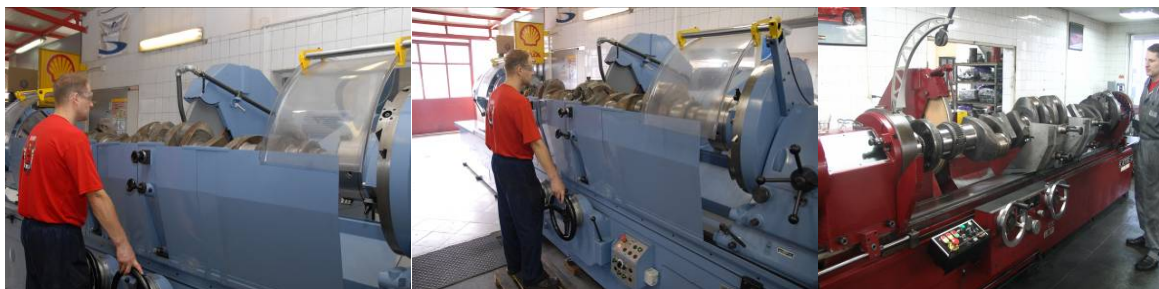
Machine pour la réalisation des axes pliés BERCO RTM 575
