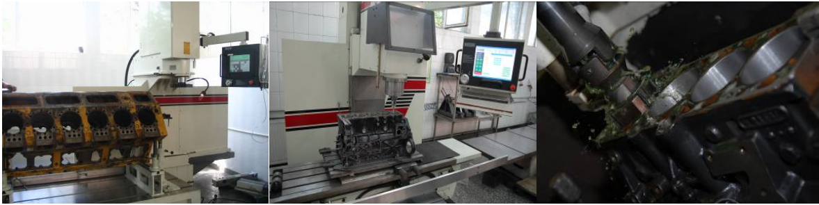
Rottler F88s une machine des plus récentes pour le façonnage des cylindres, du bâti pour bielles et de l'aplanisseur de surface
